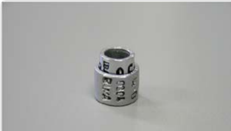
Figura 13 - Diferença de diâmetro entre uma anilha falsa, que está por fora, e uma anilha verdadeira, a de dentro.
